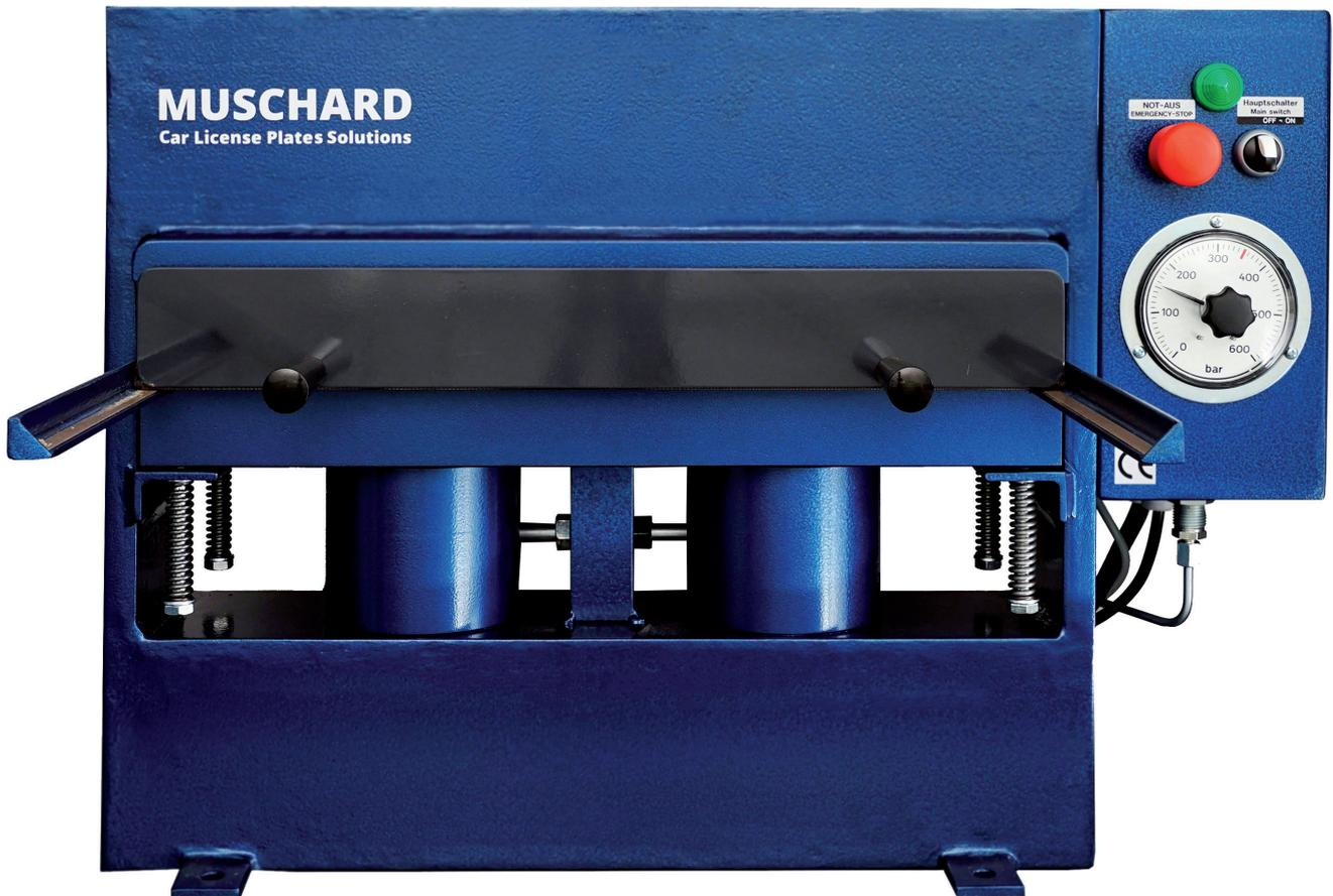
Die 35t Prägepresse ist ideal für die Endfertigung von Kfz-Kennzeichen in allen Standardformaten. Bei fortlaufender Prägung erreicht die 35t Prägepresse eine Prägegeschwindigkeit von bis zu 240 Stück pro Stunde. Unsere 50t Prägepresse ist die optimale Anlage zur Endfertigung mehrzeiliger Kfz-Kennzeichen in individuellen Formaten. In Kombination mit unseren Prägeklapprahmen ist die Prägepresse bestens geeignet, um auch filigrane Zeichen und Prägeränder präzise umzusetzen.
