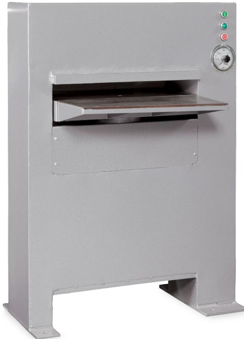
Die 80t Prägepresse ist der Klassiker unter den Prägepressen. Mit einer Prägefläche von 600 x 300 mm bietet sie etwas mehr Gestaltungsspielraum als die Prägepressen mit 35t oder 50t Arbeitsdruck.
